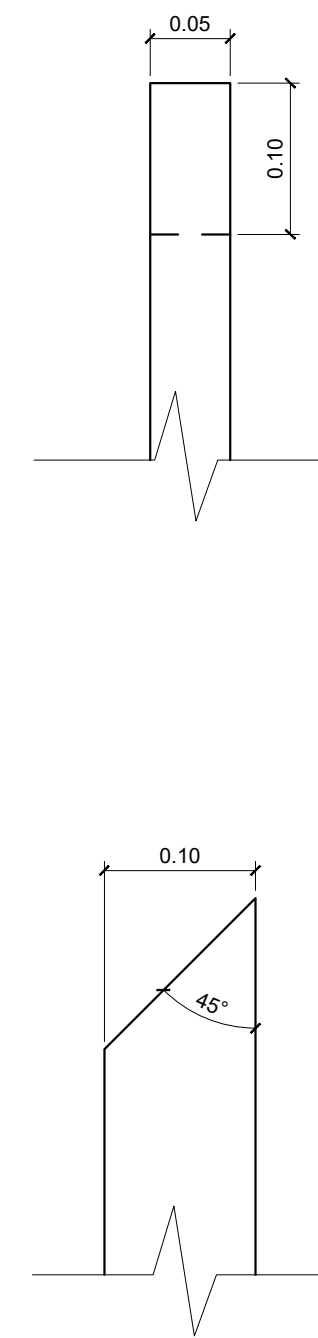
2 Detalle de Perfil 2"x4" Esc. 1:5
