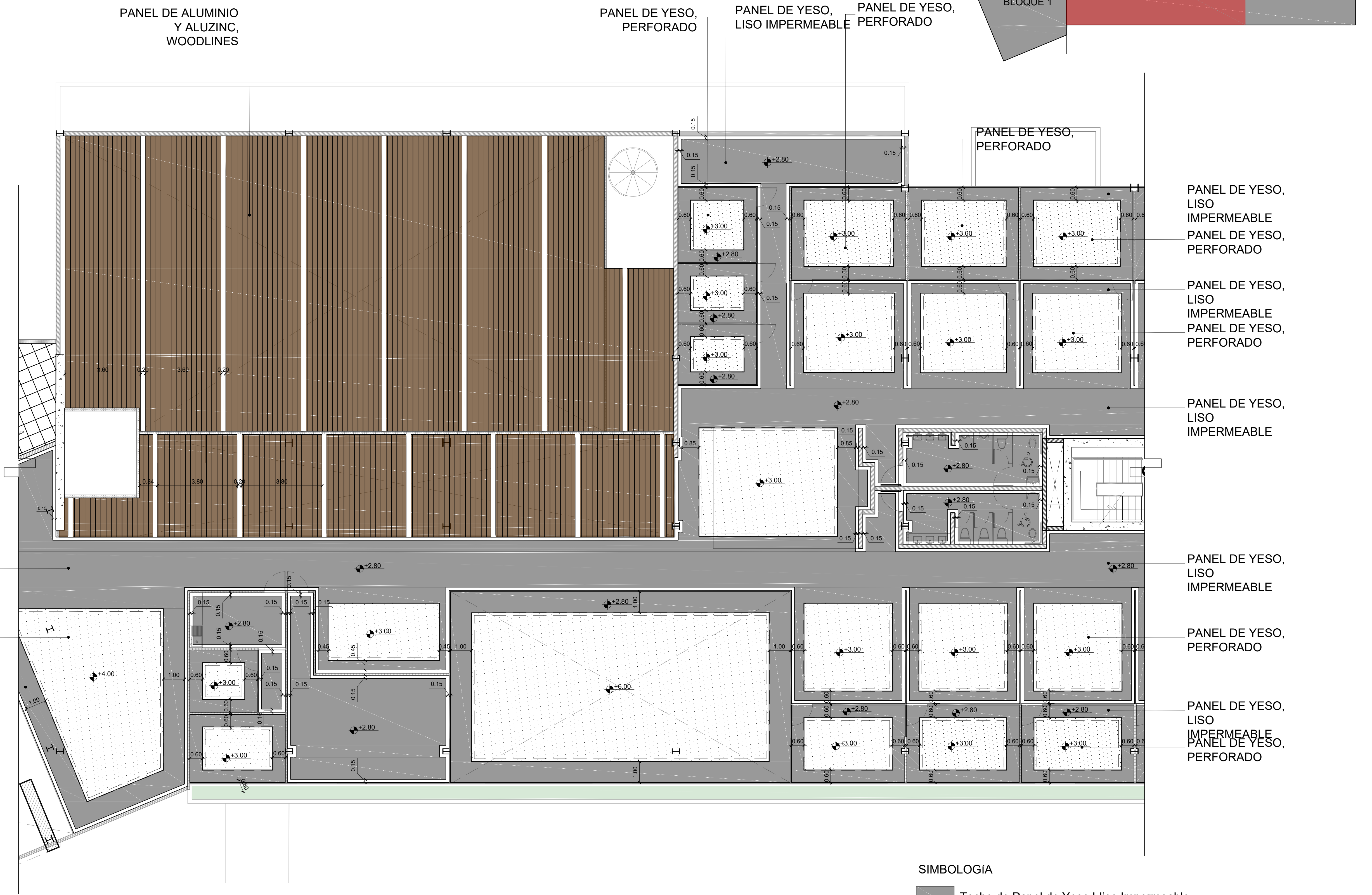
1 Planta Plafones - Nivel 4 -Bloque 2A Esc. 1:100
