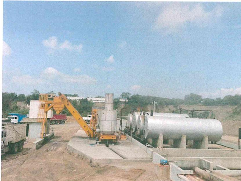
Imagen 2: Vista de tanque de almacenamiento de AC-30
