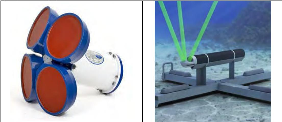
La temperatura del agua se mide con un termómetro integrado en el ADCP. La variación del nivel del agua se observa mediante un sensor de presión hidrostática, también integrado en el ADCP. Es muy importante señalar que la variación del nivel del agua medida por el ADCP no debe considerarse como la única fuente de referencia de nivel para la seguridad de la navegación.
