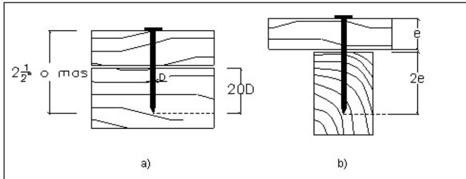
**ARTÍCULO 115.-** Cuando se unan dos elementos como los de la Figura 12, no deberán usarse clavos en la posición mostrada en la Figura 12-b, para esos casos se deberá recurrir a clavos colocados con una inclinación de unos 30°, a una distancia del extremo de la pieza en que se introducen igual o superior a una tercera parte de la longitud de los clavos (véase Fig. 12-a)
