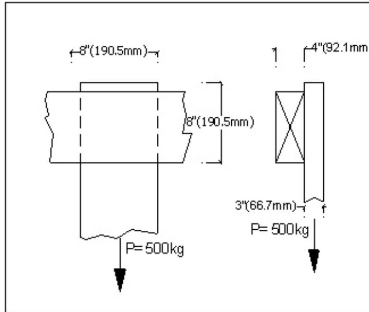
UNIÓN EN QUE LOS EJES LONGITUDINALES DE LAS PIEZAS SON PERPENDICULARES ENTRE SI
