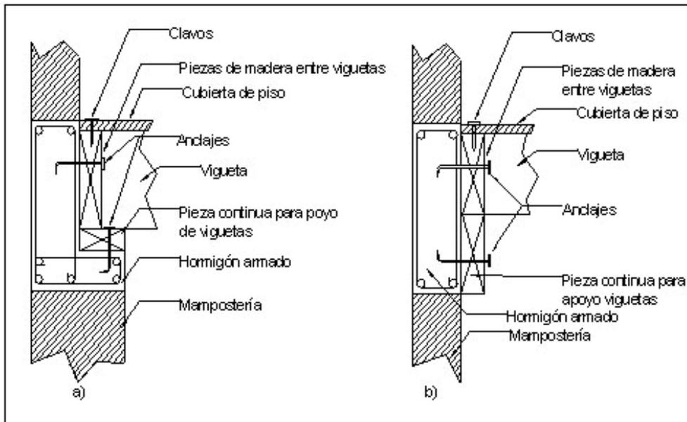
**ARTÍCULO 187.-** Las Figs. 54 (a y b) muestran dos formas de apoyar viguetas de madera, mediante listones sobre una viga principal, para lo que deberá garantizarse la funcionalidad de la unión entre los listones y la viga y entre las viguetas y los listones de apoyo, ya sea con elementos de madera o con accesorios metálicos.
