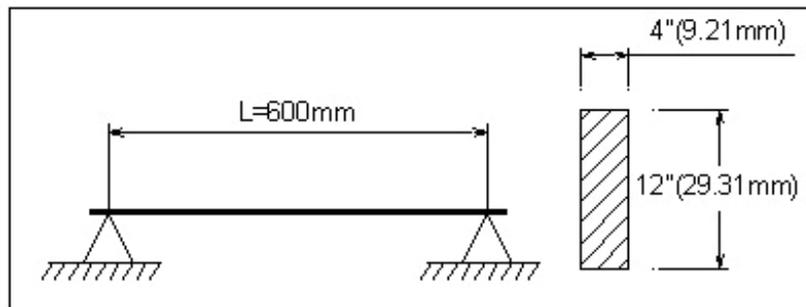
Determinar el momento admisible de las viguetas de seis metros de longitud, de un sistema de techo en el cual la cubierta no es lo suficientemente rígida para garantizar el trabajo en conjunto. Utilizar pino americano y una sección transversal de 4" x 12" (véase Fig. E3). Considerar la tendencia al pandeo lateral de las viguetas para las condiciones de apoyo de los casos siguientes:
