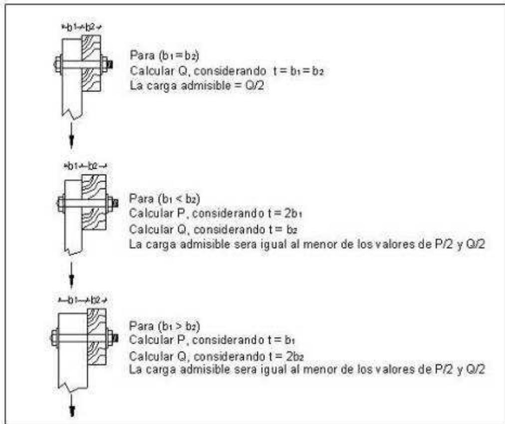
**ARTÍCULO 150.- UNIONES EN QUE SE FORMA UN ANGULO  $\theta$  , ENTRE LOS EJES LONGITUDINALES DE LAS PIEZAS.** La carga admisible de un perno en el caso en que la carga aplicada siga la dirección de las fibras en el elemento central, pero forme un ángulo,  $\theta$  , con la dirección de la fibra de los elementos laterales (véase Fig. 26-a), o viceversa (véase Fig. 26-b), se determinará con la fórmula de Hankinson, que se presenta a continuación:
