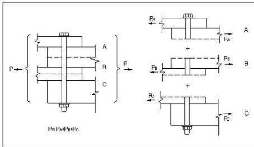
**ARTÍCULO 148.- UNIONES EN QUE LOS EJES LONGITUDINALES DE LAS PIEZAS SON PERPENDICULARES ENTRE SÍ.** La carga admisible de un perno en el caso en que los ejes de las piezas sean perpendiculares entre sí (véase Fig. 25) se obtendrá por medio de la ecuación siguiente:
