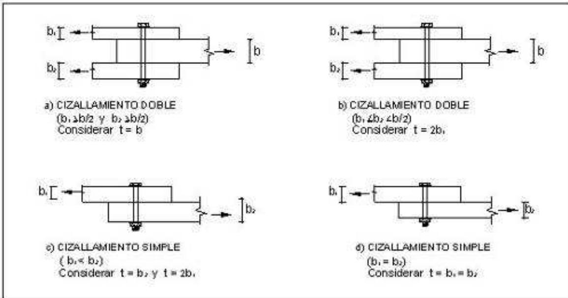
**ARTÍCULO 144.-** La carga admisible en kilogramos, en el caso en que se unan tres piezas, donde una o ambas piezas exteriores tengan menor espesor que la mitad del espesor de la pieza central ( $b_1 \leq b_2 < b_2/2$ ), deberá obtenerse mediante la Ec. 32 del Artículo 143, considerando  $t$ , igual a dos veces el espesor menor (véase Fig. 23-b).
