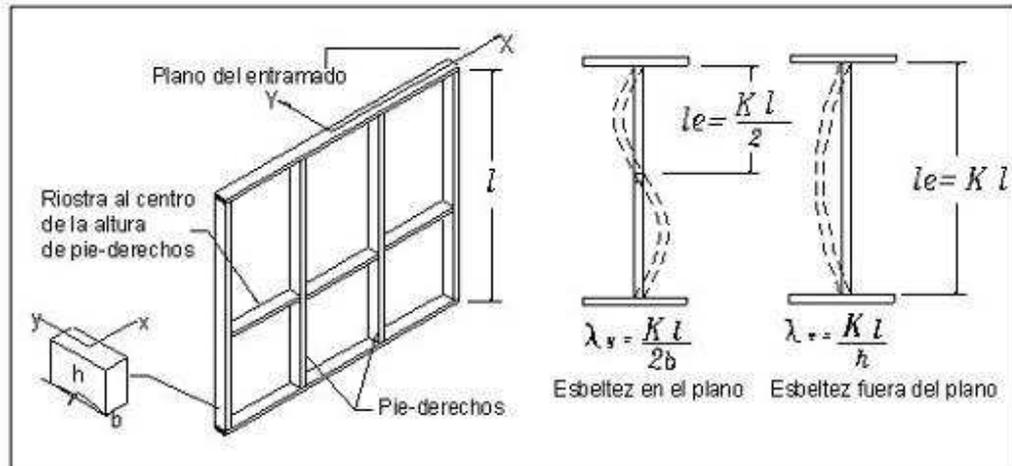
► **ARTÍCULO 76.-** Para el diseño de pies-derechos de entramados verticales, unidos mediante arriostramientos, como se muestra en la Fig. 6, cuando se considere que el revestimiento del entramado no es estructural, deberá verificarse que la dimensión menor de estos elementos esté siempre en el plano del entramado y que la separación máxima entre riostras,  $S_R$ , (véase Fig. 7) sea igual a la obtenida mediante la siguiente expresión: Véase Comentario C76.
