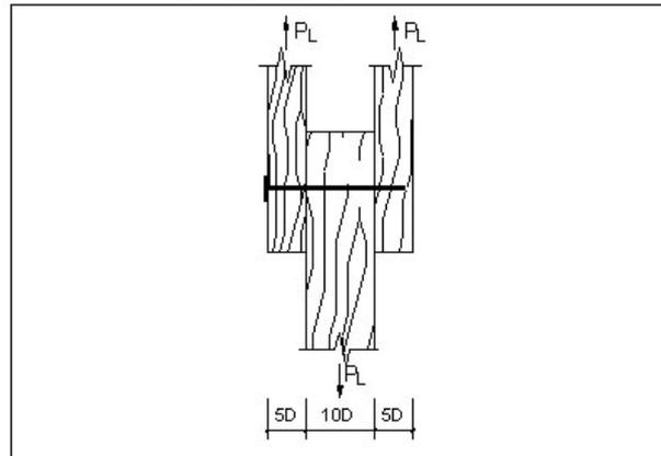
**ARTÍCULO 118.- CARGAS ADMISIBLES. FUERZAS LATERALES DE CORTE.** En una unión de dos elementos de madera, sometidos a cizallamiento simple (un plano de cortante), hecha con un clavo hincado perpendicularmente a las fibras (Fig. 13), la carga admisible en kilogramos del clavo frente a fuerzas laterales, se regirá por la expresión:
