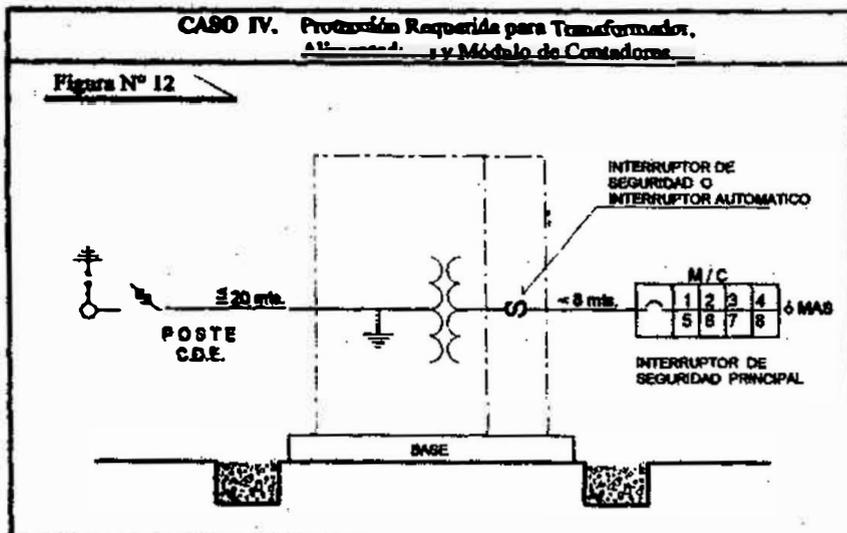
Para los casos I, II, III, y IV anteriores (Figuras 9, 10, 11, y 12) cuando la distancia entre el poste y el cubículo (Transclosure) sea mayor de veinte (20) Mts., deberán llevar un interruptor de seguridad antes del transformador, según se indica en la Figura No. 13 que sigue:
