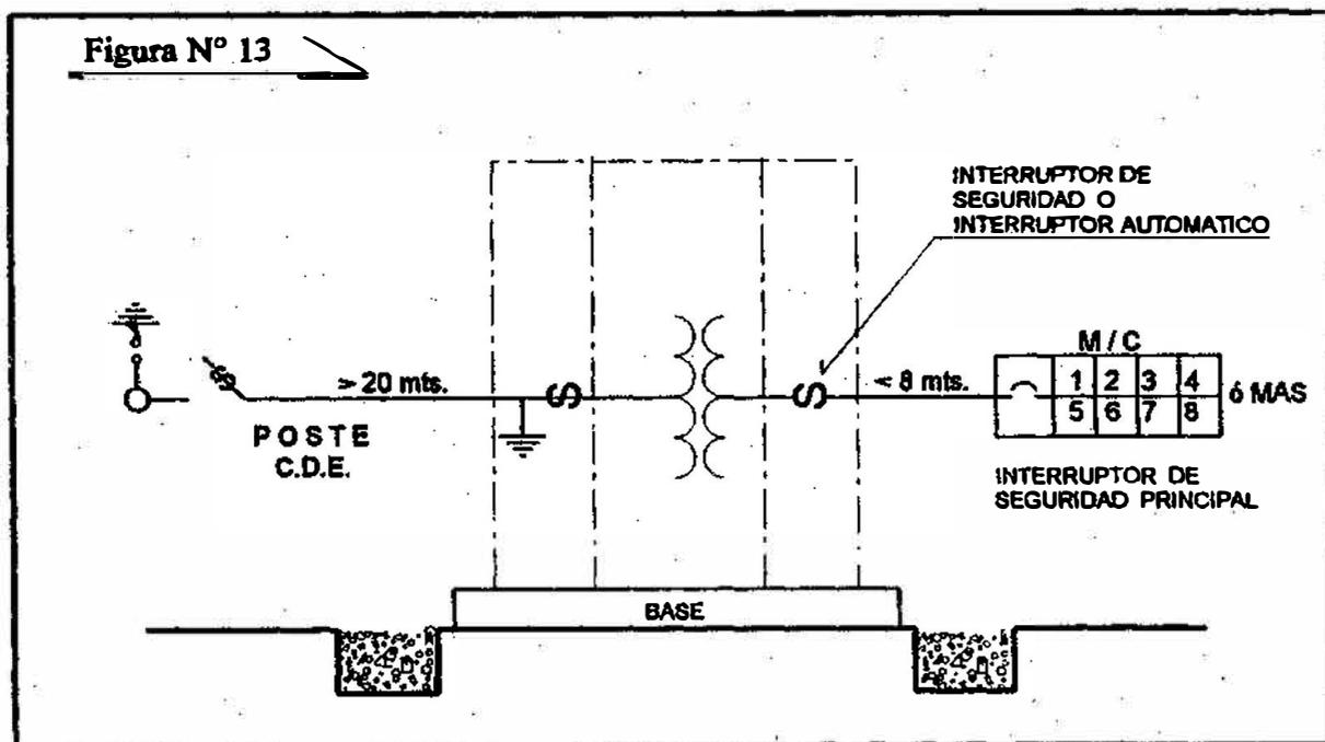
La instalación del juego de interruptores (Cut-Out) y pararrayos en el poste de la CDE es de carácter obligatorio, para fines de conexión y desconexión de energía desde la vía pública, por parte de la CDE.
