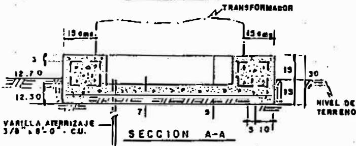
PLATAFORMA DE CONCRETO PARA SUB-ESTACION TIPO PAD-MOUNTED
