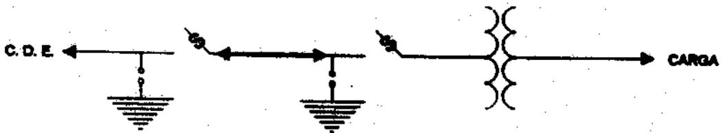
**Subestación con alimentación soterrada.**
