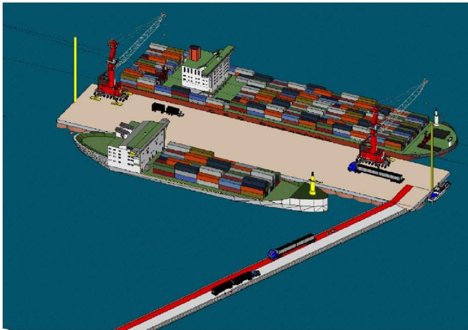
Se trata de un muelle tipo sólido con 16 metros de calado, con un frente de atraque de una longitud de 242 m, que se conformará mediante 6 celdas circulares de 30.10 m de diámetro ejecutadas con tablestacas planas de acero interconectadas con arcos también de tablestacas planas. Las celdas se rellenan con material granular seleccionado proveniente de canteras habilitadas existentes en tierra o bancos de materiales granulares en el mar.
