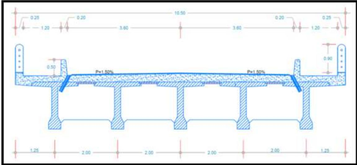
Figura No.3: Sección Viga Tipo T
