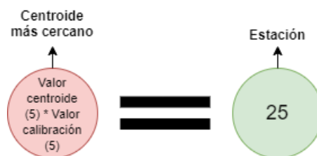
Ilustración 51: Calibración de centroides asignados a estaciones.
