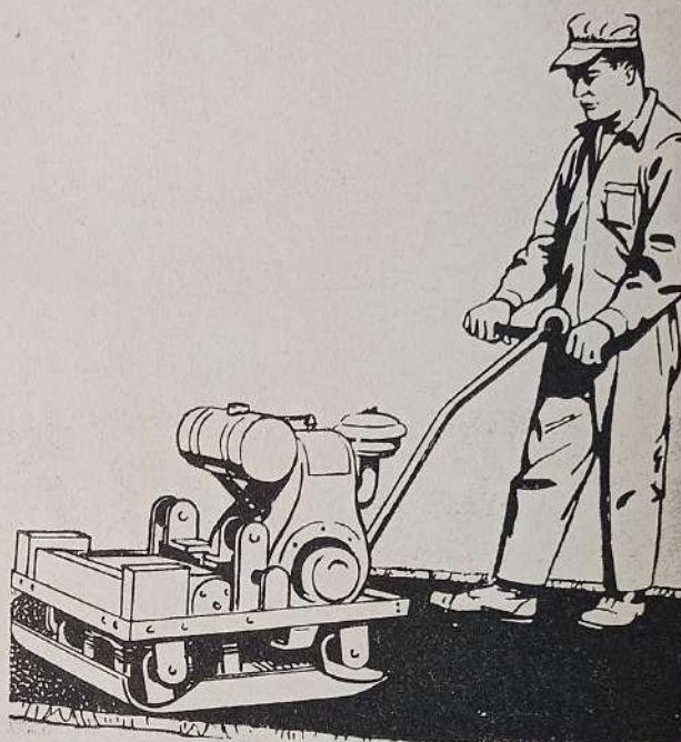
Fig. Núm. 10 - Compactando con Compactador de Plato Vibratorio.
