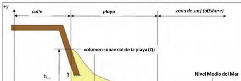
Los datos del levantamiento topográfico obtenidos durante las mediciones se incluirán en hojas de cálculo electrónicas y posteriormente se transformarán en gráficos mediante programas informáticos especializados. Los datos se compararán entre los meses para determinar el balance de los sedimentos en las playas analizadas. A continuación, se ejemplifica la toma de perfiles de playa con los gráficos comparativos en cada campana de monitoreo.
