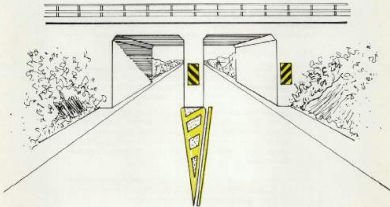
FIGURA 3.17 — Instalación típica de delineadores.
