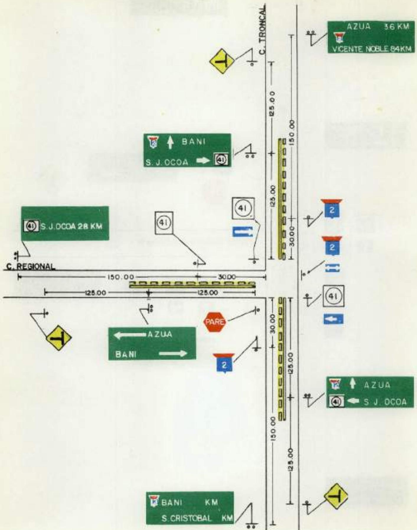
FIGURA 2.6 – Señalamiento típico para intersección de una carretera troncal con una local.
