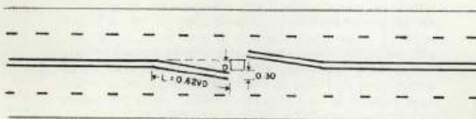
RAYA CONTINUA DOBLE PARA INDICAR EL PASO DE LOS VEHICULOS POR UN SOLO LADO DE UN OBSTACULO, SITUADO EN EL EJE DE UNA VIA DE CIRCULACION DE CUATRO CARRILES.
