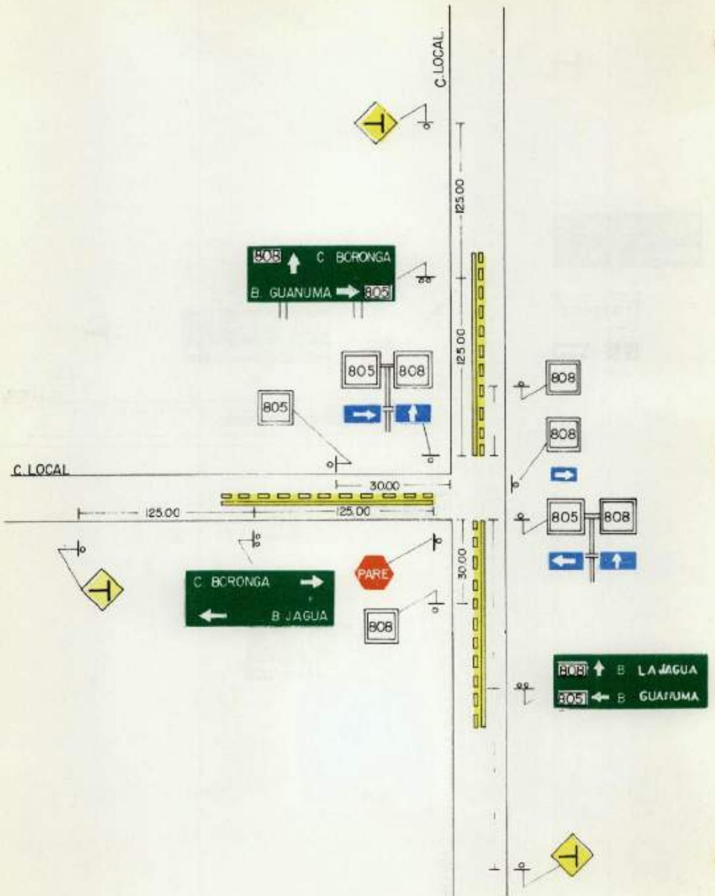
FIGURA 2.10 — Señalamiento para puente angosto.
