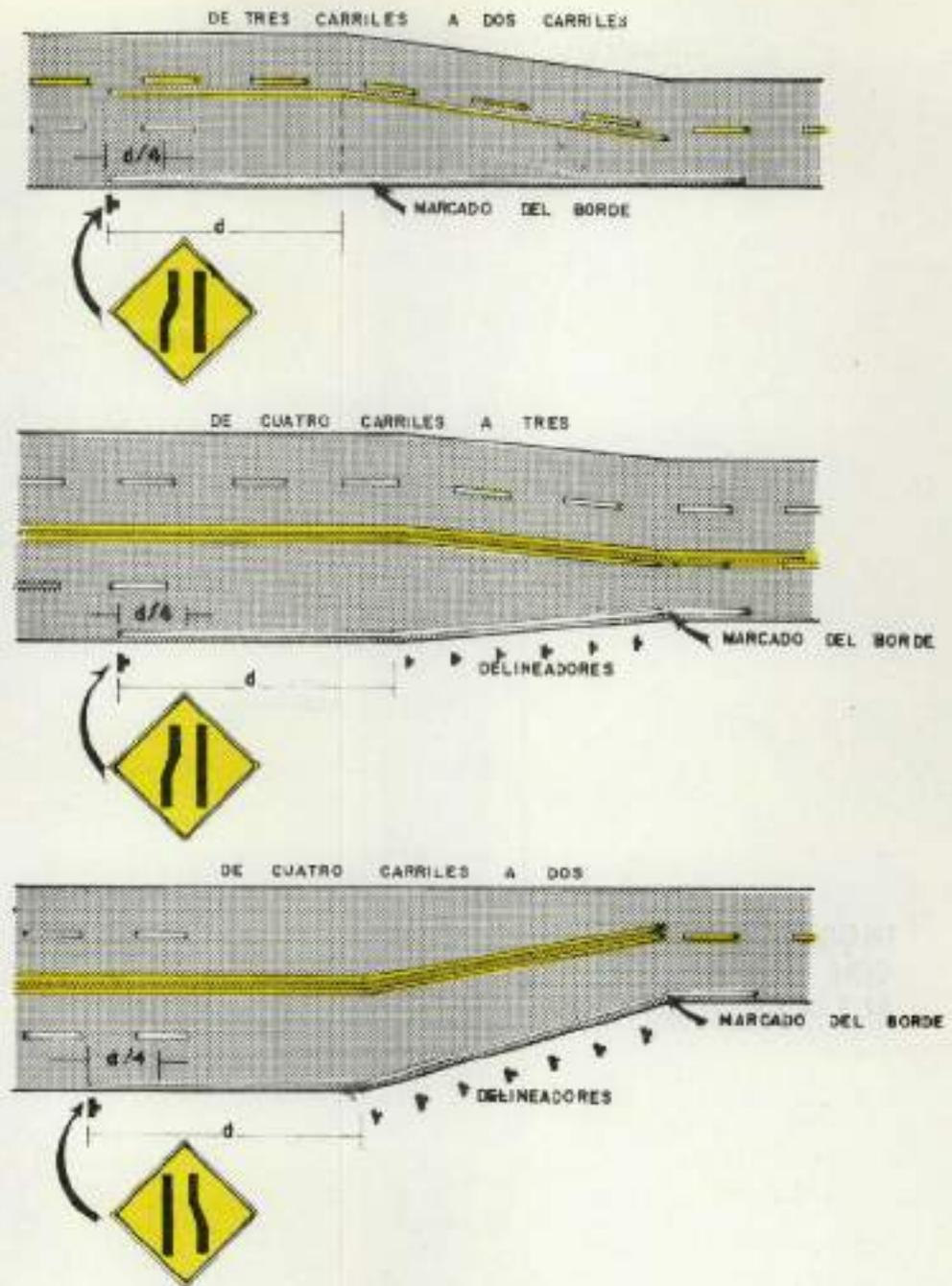
FIGURA 3.6A — Línea de canalización.
