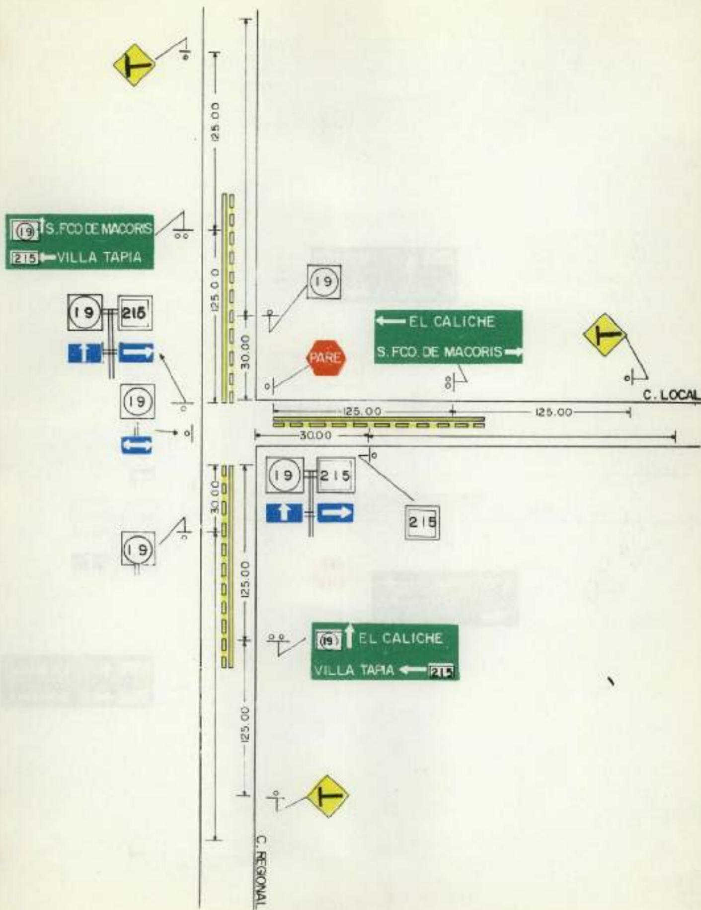
FIGURA 2.9 — Señalamiento típico para intersección de carreteras locales.
