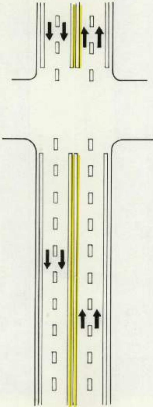
FIGURA 3.2 — Aplicaciones de marcado típico para carretera de dos carriles.
